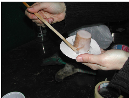
Figure 11: Spreading glycerolo on the stopper n.1
