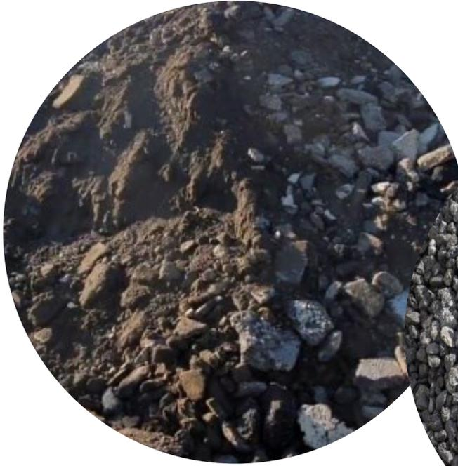
**Materiale di demolizione di vecchie pavimentazioni (Fresato - RAP)**
