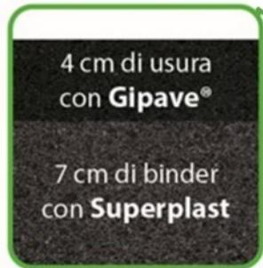
(+15 cm di base con Superplast, solo per le rampe di accesso)
