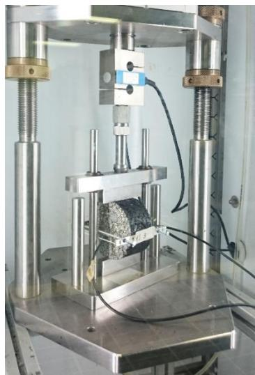
Norma di riferimento: UNI EN 12697-24, Annex E (trazione indiretta su provini cilindrici)
