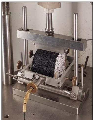
Norma di riferimento: UNI EN 12697-26, Annex C (trazione indiretta su provini cilindrici)
