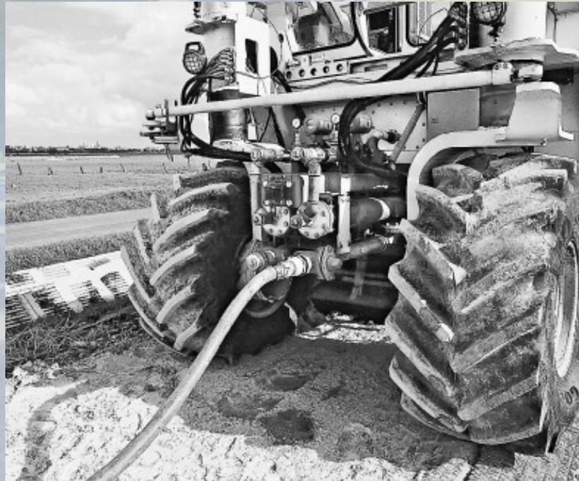
**1996 Viene messo a punto un sistema d'iniezione per la schiumatura del bitume.**
