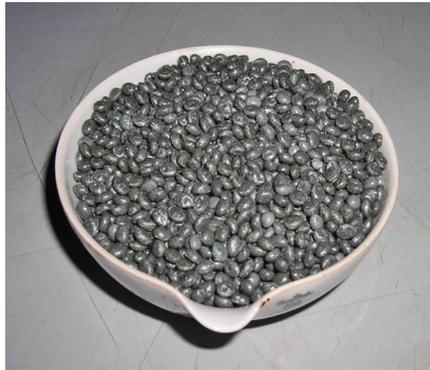
4. Il compound polimerico contenente LDPE e EVA utilizzato per migliorare il conglomerato bituminoso (Celauro et al.)
