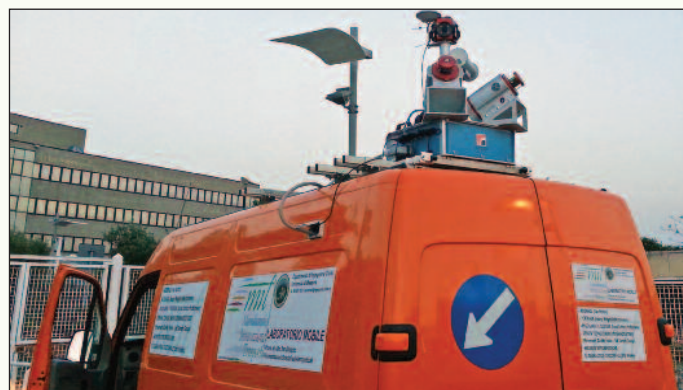
5. Il sistema MMS (Mobile Mapping System) montato sul laboratorio mobile
