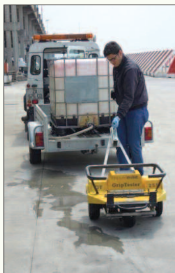
2. Il Grip Tester per il rilievo dell'aderenza
