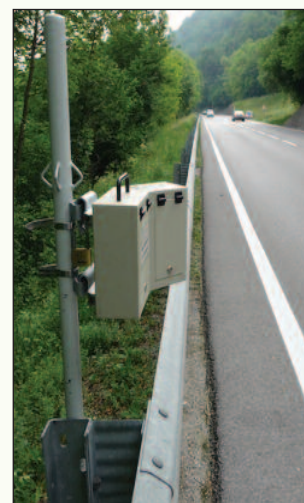
3. La strumentazione in postazione fissa per il monitoraggio del traffico
