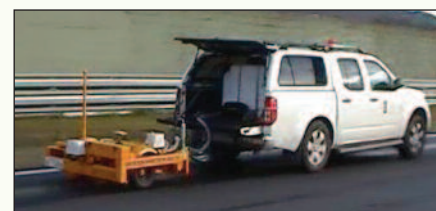
5. Lo skidometro della Provincia di Perugia per la misura dell'aderenza
