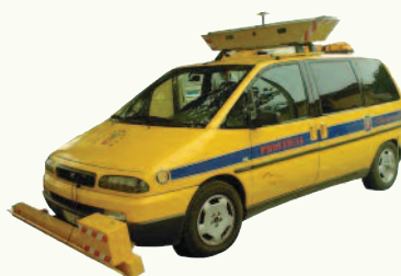
7. Un prototipo di profilometro per la misura della regolarità realizzato dall'Università di Perugia attraverso una convenzione con la Provincia di Perugia
