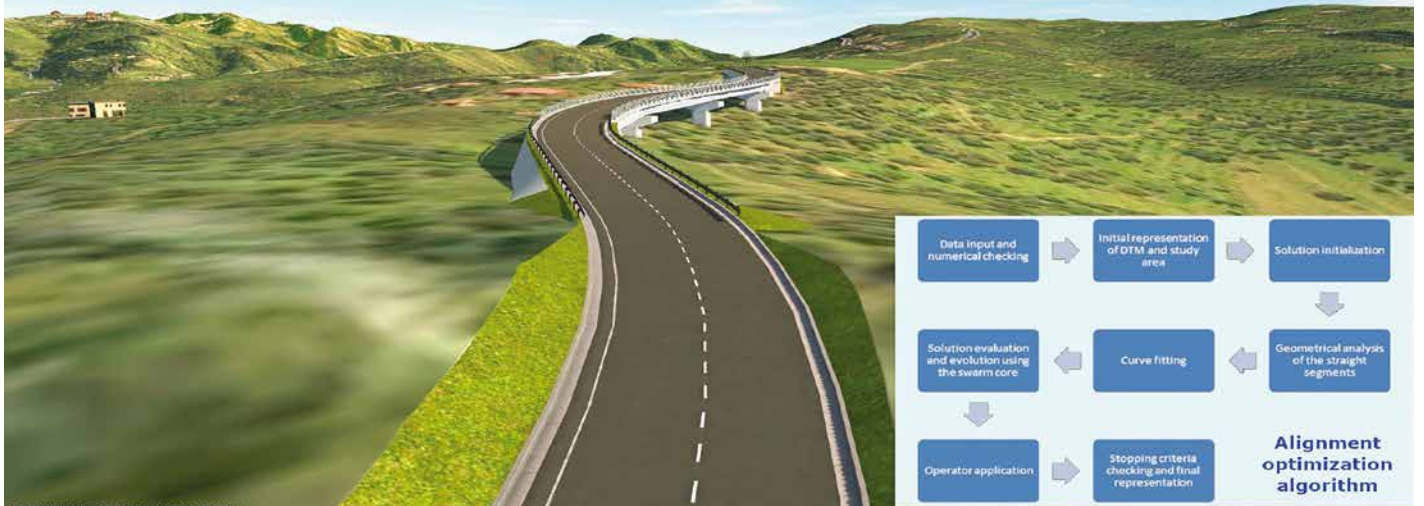
2. La rappresentazione di un tracciato in ambiente I-BIM e diagramma di flusso dell'algoritmo di ottimizzazione dei tracciati stradali (Bongiorno et al.)
