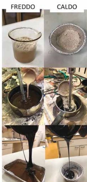
1. La preparazione dei provini contenenti refluo di jet grouting (Veropalumbo et al.)
