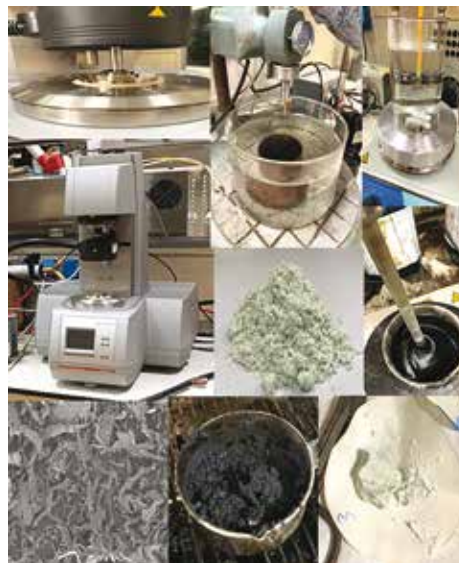
3. Studio delle proprietà reologiche dei mastici bituminosi a caldo realizzati utilizzando rifiuti plastici come filler (Veropalumbo et al.)
