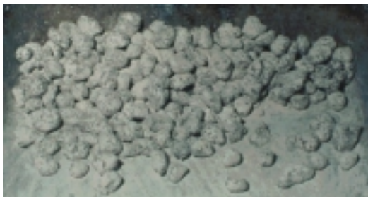
Figura 4 – Terra di classe IV miscelata con calce
