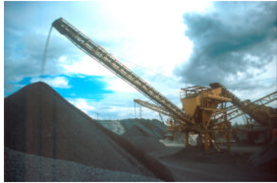
Figura 2 – Fase finale della lavorazione delle scorie.
