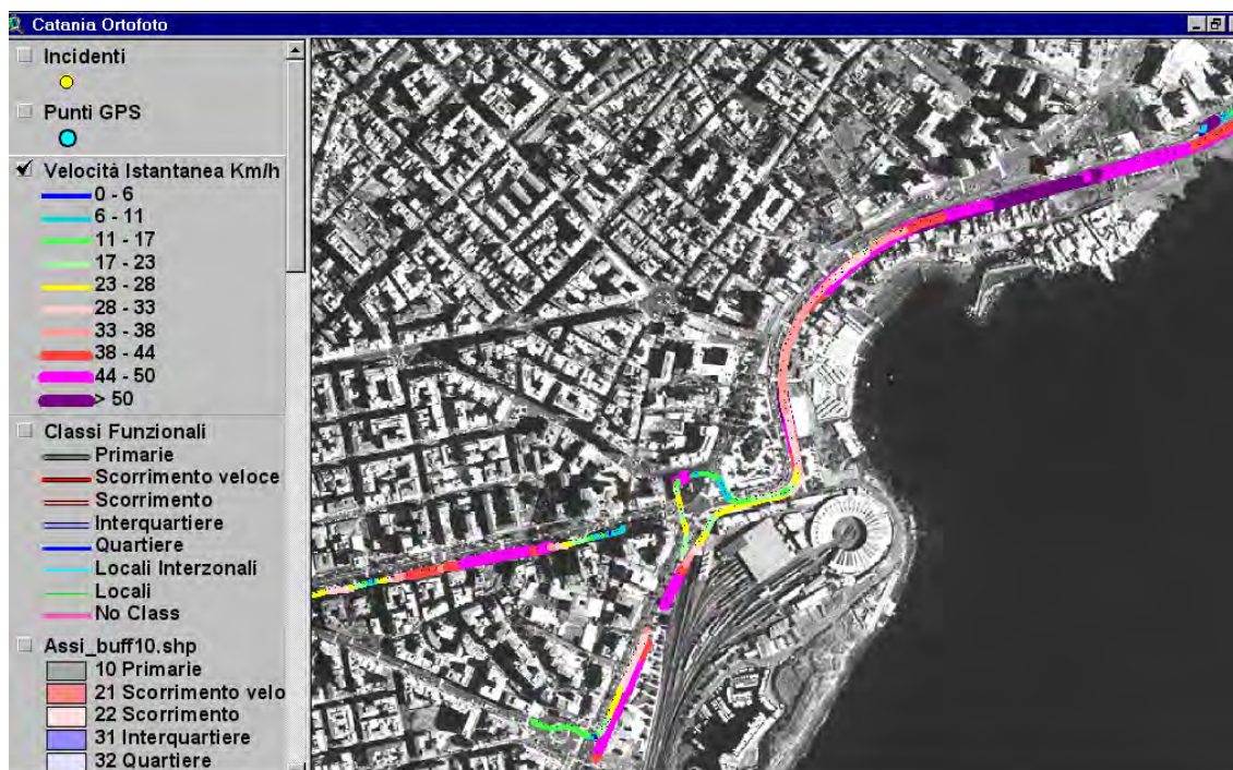
Figura 9 – Diagramma delle velocità rilevate (Km/h) su Corso Italia, Viale Africa, Viale Ruggero di Lauria e la rotatoria di Piazza Europa
