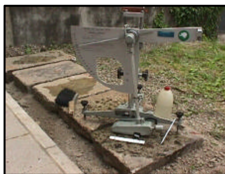
Figura 8 – Skid test su pavimentazioni in pietra.
