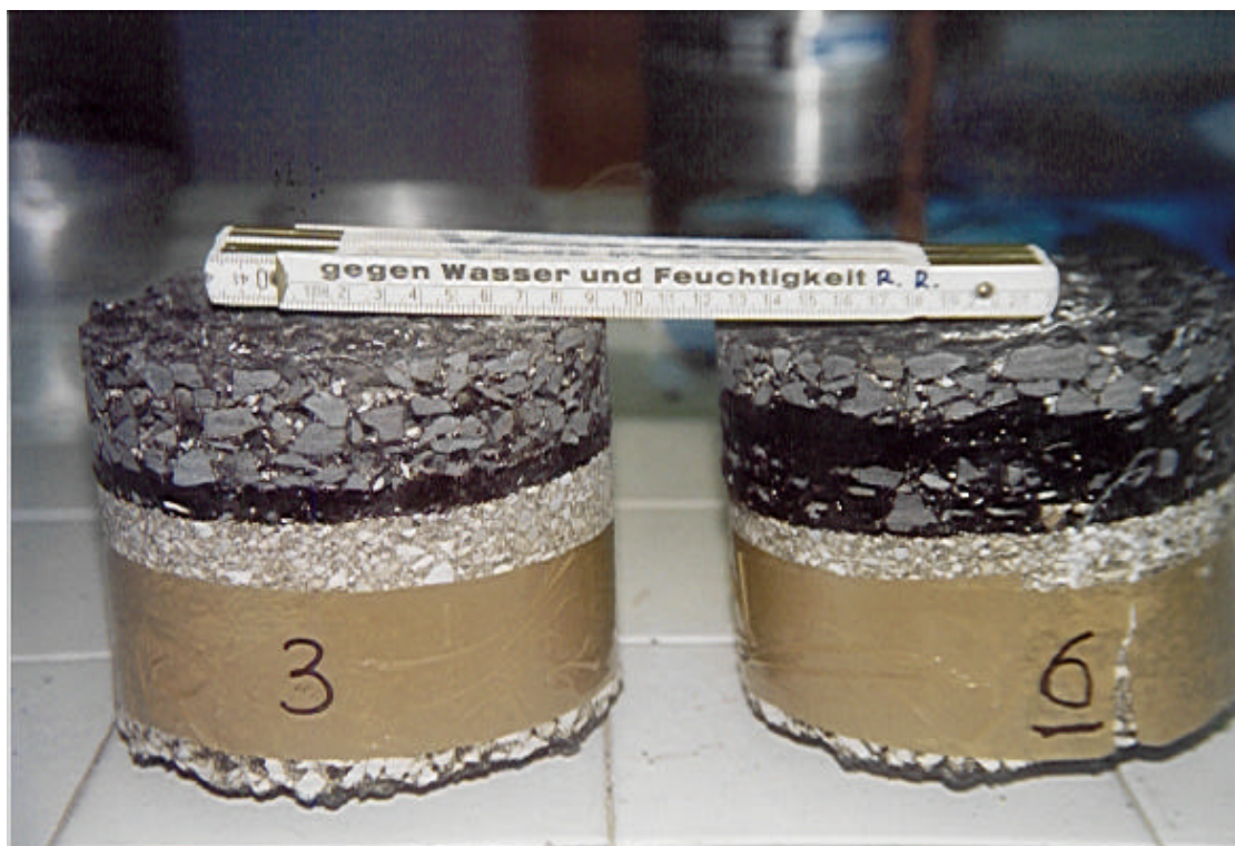
Figura 3 - Carote estratte dalla corsia di marcia e dalla banchina.
