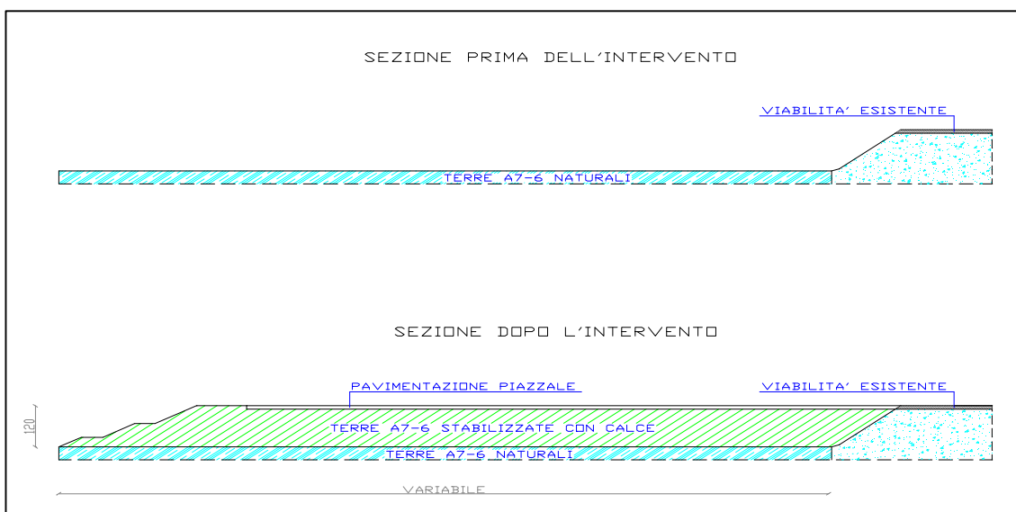
Figura 2 – Interporto Toscano A. Vespucci: sezioni stato di fatto e di progetto.
