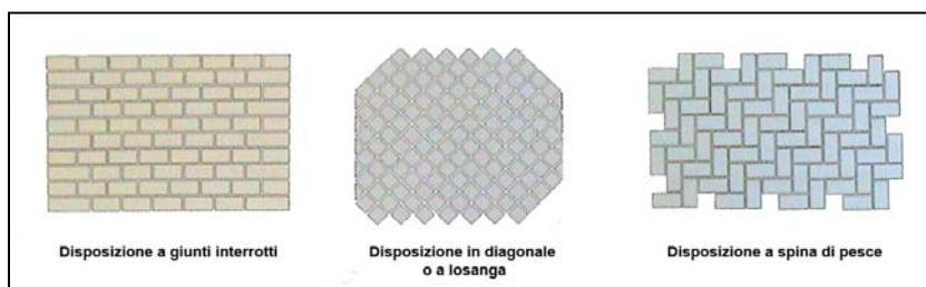
**Figura 9 - Tipologie ottimali di disposizione degli elementi costituenti la pavimentazione**
