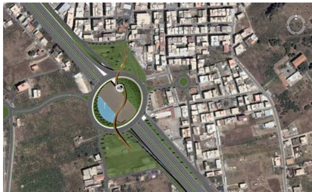
Figura 6 - Lo svincolo di Bagheria nella situazione di progetto
