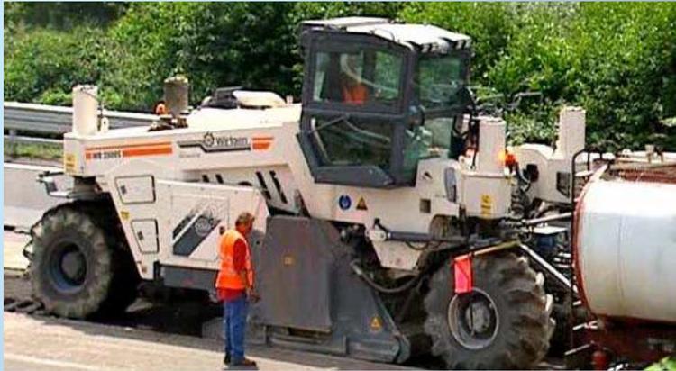
Mediante appositi ugelli, il bitume espanso viene iniettato all'interno della "camera di espansione" per essere successivamente **mescolato con gli aggregati**.
