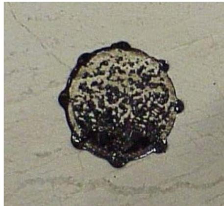
Rottura per adesione
