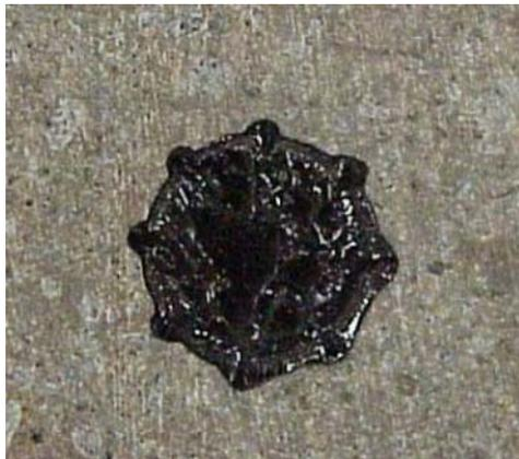
Rottura per coesione
